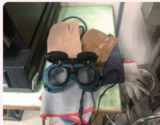
視傳系金工教室（特殊作業防護具、耐熱手套與強光護目鏡）
